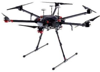
Opción 1: DJI Matrice 600 Pro (para adaptarse a la LiDAR-eco + cámara)
